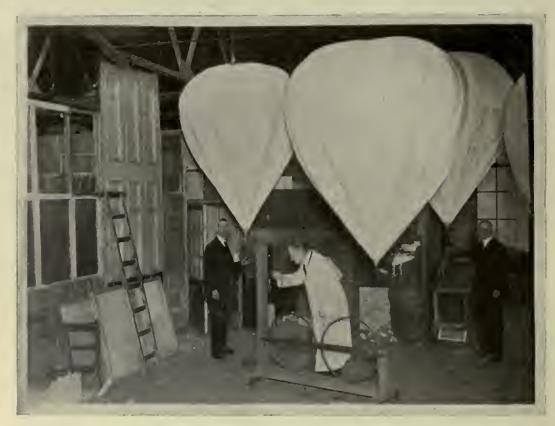
TESTING LIFTING POWER OF PAPER BALLOONS.
